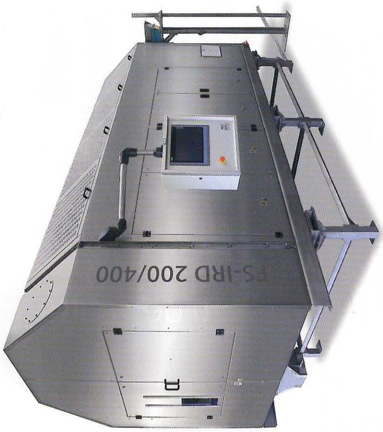
Das FoodSafety-IRD Verfahren ist ein thermisches Verfahren, das die Wärme dem Rohstoff gezielt durch Infrarotlicht zuführt
